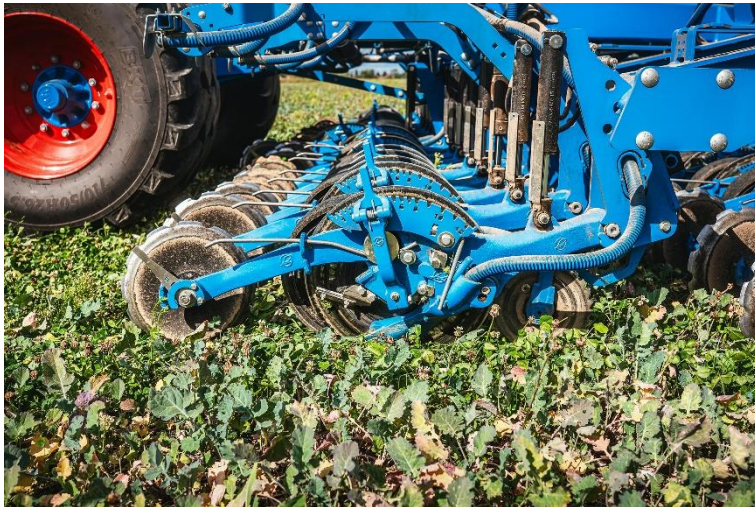
Bild 2: Das Säschar ProDisc ermöglicht eine exakte Applikation bei minimaler Bodenbewegung.
